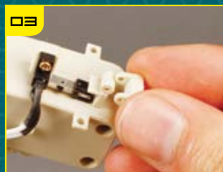
03 Установите шарнир на короткий конец приводного рычажка, совместив отверстия.
