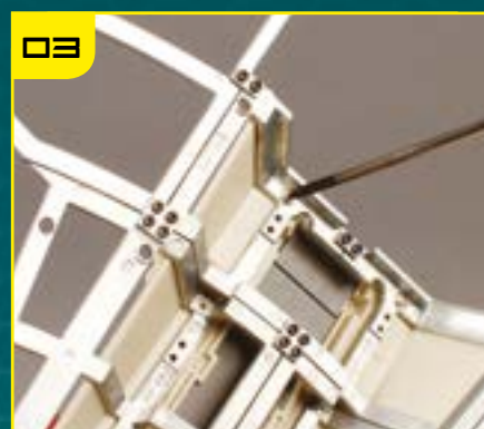
03 Зафиксируйте обшивку на каркасе с помощью восьми серебристых винтов.
